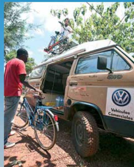
El vehículo se desplazó con alrededor de 2.300 kilos a lo largo de toda esta aventura, con parte de la carga ubicada en el techo, lo que supone una gran exigencia para las suspensiones en cuanto al control del "balanceo" de la carrocería.
